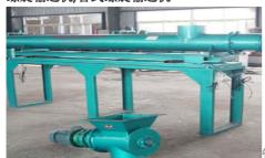
管式螺旋输送机是利用螺旋旋转而推移物料的连续输送设备,适用输送面粉、
